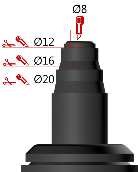
Kapping av rørgjennomføring
