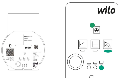
Wilo Para 25-130/8-75/SC display med fabrikkinnstilt display.
